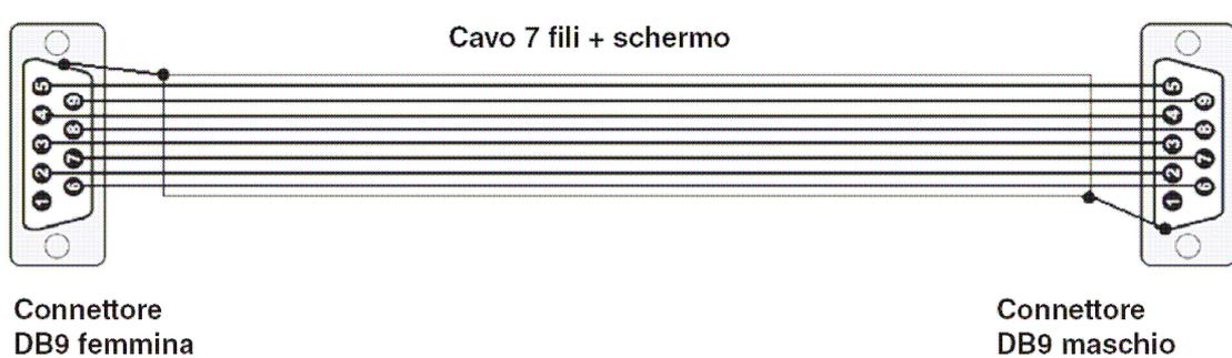
*Schema del cavo seriale per il collegamento dal PC alla centrale della Centrale.*
