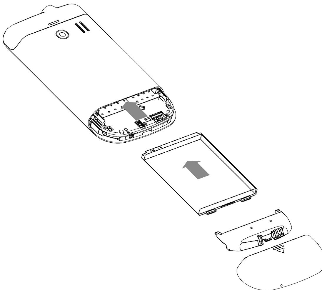
**Nota:** installate la batteria seguendo il diagramma riportato qui di seguito, in modo da evitare possibili danni ai contatti.
