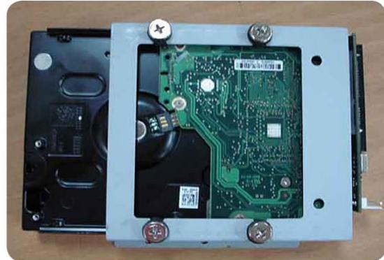
2. Assemblare il convertitore SATA avvitando solo l'angolo superiore destro come illustrato in basso.
