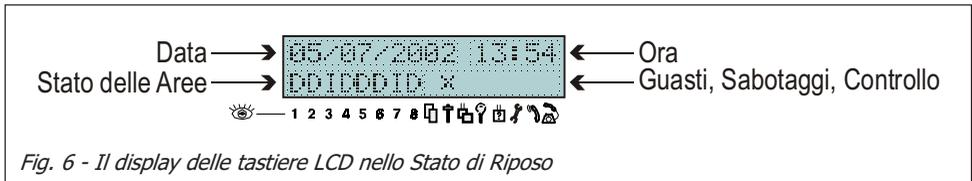
Fig. 6 - Il display delle tastiere LCD nello Stato di Riposo
