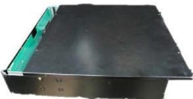
**Fig. 2.7.** Richiusura del pannello superiore mediante le 4 viti
