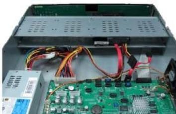
**Fig. 2.6.** Connessione con il cavo SATA e con l'alimentazione
