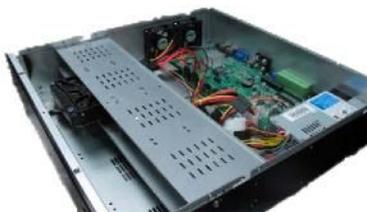
**Fig. 2.5.** Posizionamento dell'HDD in uno slot libero e fissaggio con le 4 viti
