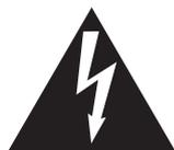
Il simbolo raffigurante un lampo all'interno di un triangolo, avverte della presenza, all'interno dei componenti dello strumento, di un "voltaggio pericoloso" di rilevanza tale da costituire rischio di scarica elettrica.
