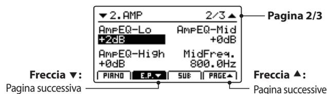
Ruotare i potenziometri di controllo (A, B, C, D) per regolare i parametri Lo, Mid, Hi, e MidFreq EQ.
