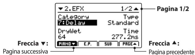
Ruotare i potenziometri di controllo (A, B, C, D) per variare la categoria e il tipo di effetto e regolare i parametri dell'effetto aggiuntivo.
