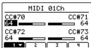
Ruotare i potenziometri di controllo (A, B, C, D) per regolare il parametri di variazione controllo MIDI assegnati a quello specifico potenziometro.
