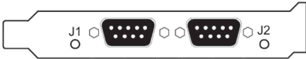
Il collegamento delle NET avviene mediante cavo seriale RS-485 direttamente ai connettori "J1" e "J2".
