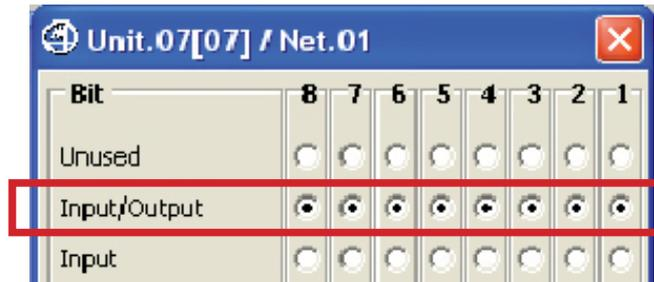
Così facendo l'attribuzione degli ingressi/uscite digitali di ogni singolo bit sarà completamente gestita dall'applicazione *Flow-Control* (vedi esempio sottostante).
