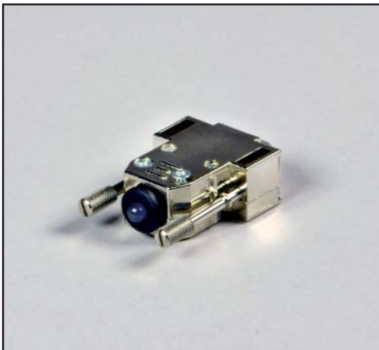
Il connettore di fine rete viene inserito come elemento di chiusura di ogni NET, fisicamente applicato sull'ultimo modulo *DigiCrown bus*.
