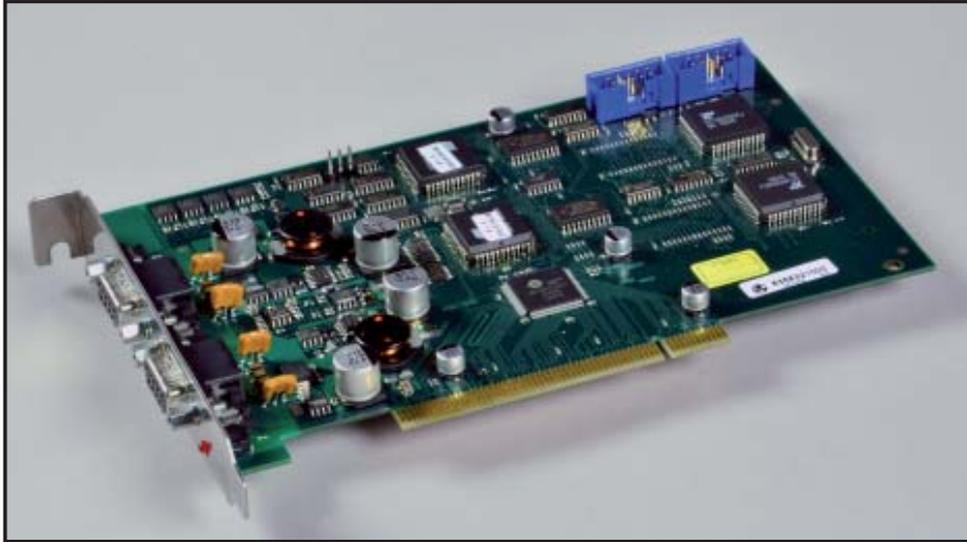
L'unità *DigiCrown pci* realizza la comunicazione seriale RS485 Half Duplex con il resto della rete. Ogni scheda è dotata di due porte seriali, per una gestione complessiva di 31 + 31 sensori oppure moduli I/O.
