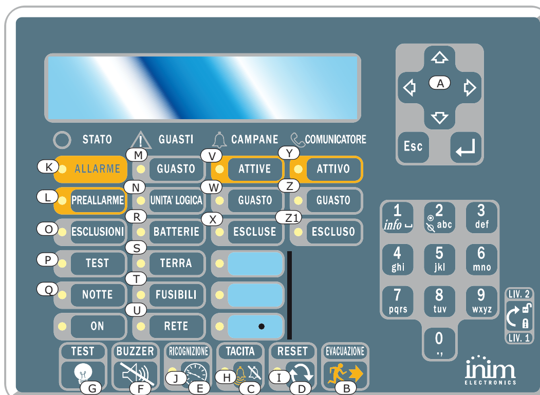
Figura 8 - Vista frontale repeater
