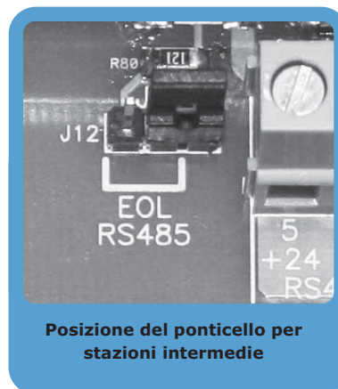
Figura 16 - Scheda SmartLetUSee/LCD-Lite - posizione del ponticello
