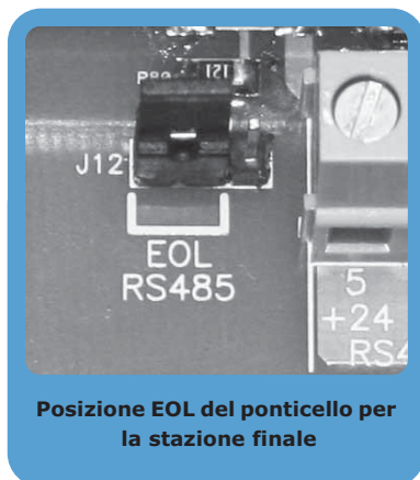
Figura 17 - Scheda SmartLevel - posizione del ponticello
