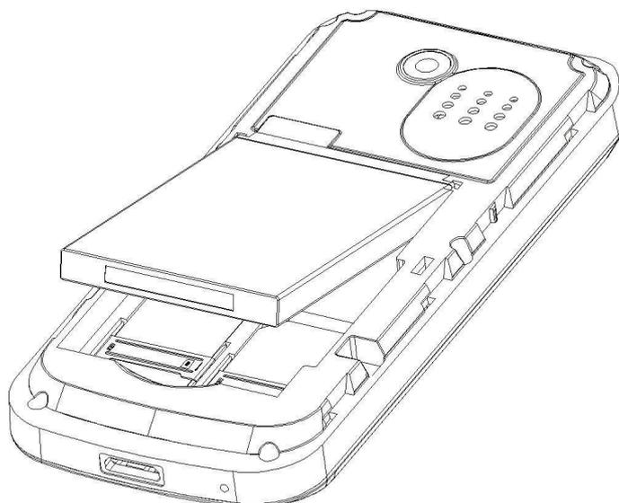
**Attenzione:** Installare secondo l'illustrazione precedente per evitare di rompere i connettori della batteria.
