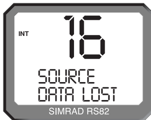
Fig 11.2 - Perdita della sorgente dati nav SimNet
