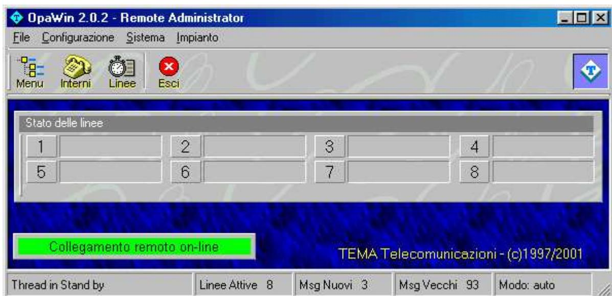
In basso a sinistra compare lo stato della connessione. A questo punto è possibile iniziare a programmare il sistema come se ci si trovasse sul posto, oppure semplicemente controllarne il funzionamento tramite lo stato delle linee.
