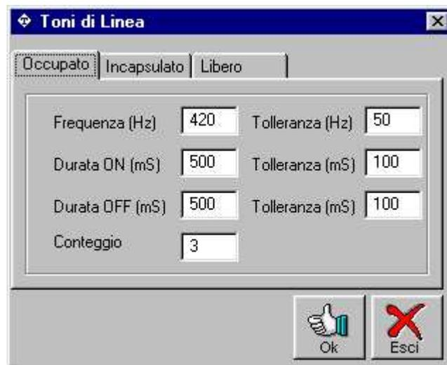
La frequenza si riferisce alla frequenza del segnale da riconoscere (di norma 425 Hz). Le durate, espresse in mS (millisecondi), si riferiscono invece alla durata della presenza del segnale e dell'assenza di segnale. Il conteggio, invece, stabilisce quanti toni la scheda debba contare prima di considerare un segnale valido.
