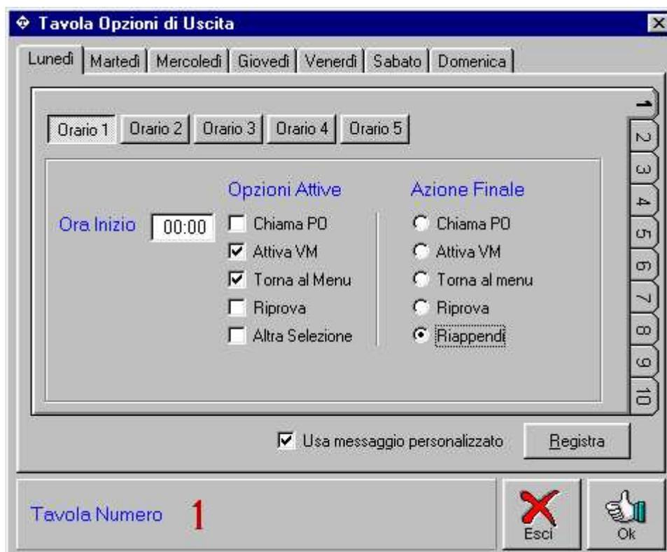
La selezione delle diverse tavole di uscita avviene scegliendo tra una delle 10 tabelle sul lato destro della maschera. Per ogni tavola di uscita è possibile impostare 5 fasce orarie per ogni
