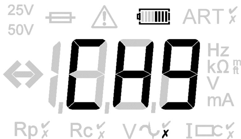
4. Lo stato del circuito del caricatore è mostrato o con una crocetta o con un segno di spunta indicati sotto le lettere 'CHG'. Una croce indica che il circuito del caricatore è disabilitato.
