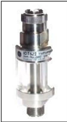
Impedisce la contaminazione del sistema pneumatico del DPI611 nonché la contaminazione incrociata da un dispositivo in prova ad un altro. La trappola si collega direttamente alla porta di pressione e replica l'attacco rapido del DPI611 per il collegamento di adattatori standard, kit di adattatori e tubi flessibili.
