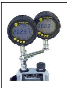
Per una maggiore efficienza, è possibile collegare due dispositivi di prova contemporaneamente. L'adattatore si collega alla porta di pressione del dispositivo DPI611 ed è dotato di due porte di uscita. È compatibile con gli adattatori standard forniti e i kit di adattatori.
