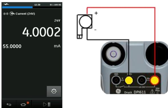
**Figura 2-18 Misura di un flusso di corrente su canale elettrico (gamma  $\pm 55$  Ma)**
