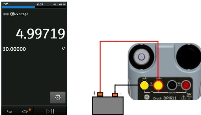
**Figura 2-21** Misura dei Volt CC o mV CC su canale elettrico.
