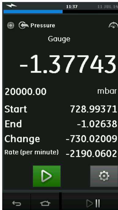
Figura 2-25 Esempio di test di tenuta
