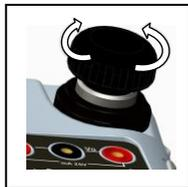
**Figura 1-4** Valvola di rilascio della pressione
