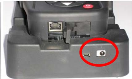
Esistono due modalità di ricarica dello strumento:
