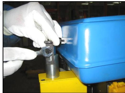
Figura 3 – Fissaggio e regolazione fine dell'asta.
