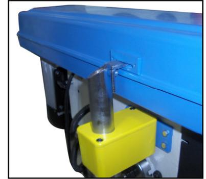
Figura 15 – Blocco del vano pulegge
