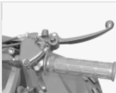
Se il livello risulta essere al minimo, aggiungere olio specifico per freni. Azionare la leva del freno anteriore e verificare nuovamente il livello.
