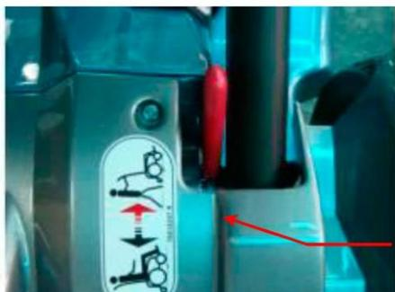
Leva di sblocco ruote/La forza massima richiesta sulla leva è pari a 19 N per l'innesto e 35 N per il disinnesto.
