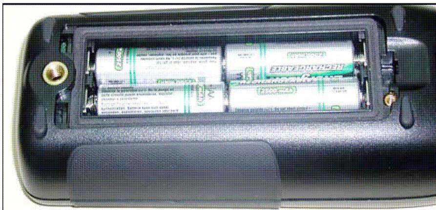
**FIGURA 2-7 Inserimento Batterie**
