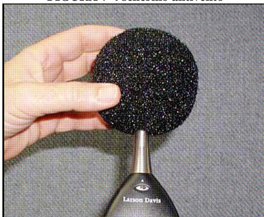
FIGURA 7-5 montaggio dello schermo
