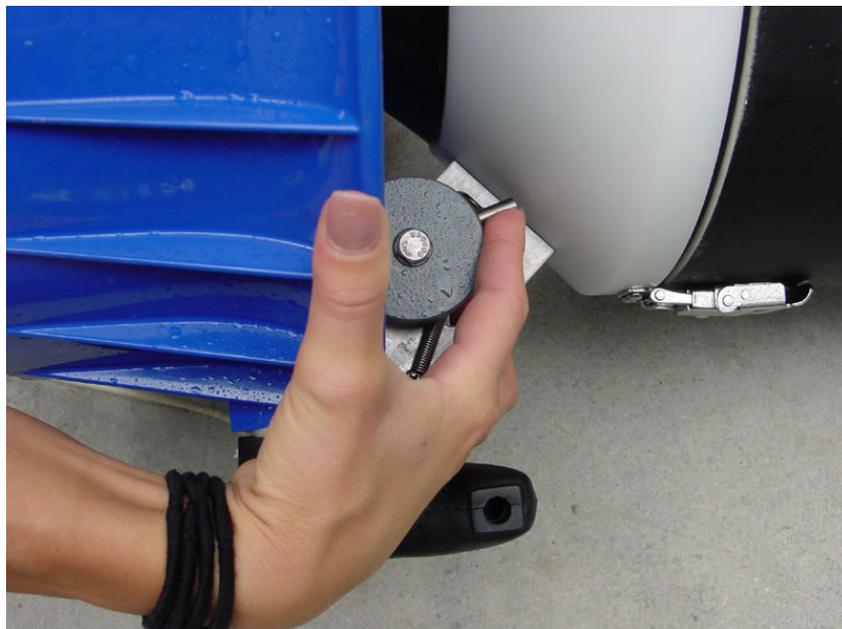
Di solito il modo in cui il cavo si rompe è impigliandosi in qualcosa durante il trasporto. Io ho provato a tenere il magnete più vicino possibile alla coda in modo che non sporga. Io inoltre non uso quella gamba come maniglia per il trasporto. Su alcuni scooter, soprattutto per la versione tapered, ho rovesciato la direzione del magnete così da doverlo tirare dall'interno all'esterno. Comunque, è più difficile da utilizzare se rotto
