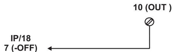
**Figura 7** Esempio di collegamento di un sensore con memoria a comando negativo
