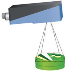
Quando si utilizza un Inspector con illuminatore ad anello, l'Inspector potrebbe essere montato leggermente inclinato per evitare riflessioni eccessive.
