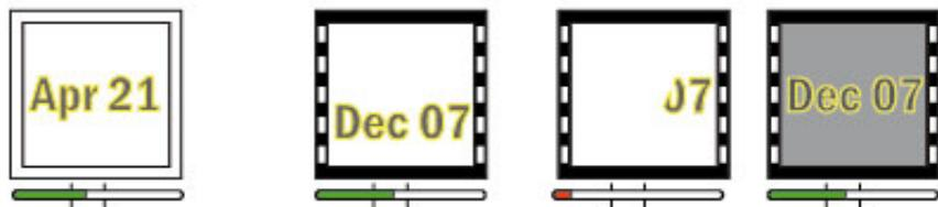
Figura – Il Contatore pixel sul bordo conteggia i pixel sul bordo e confronta tale numero con l'impostazione **N. pixel sul bordo**. La posizione dei pixel non è importante.
