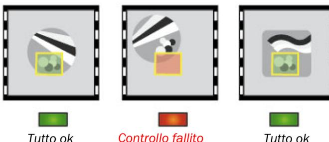
Figura - Quando Inspector controlla senza localizzare, le ispezioni vengono sempre eseguite nello stesso punto del campo visivo.
