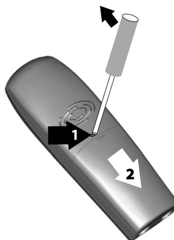
Rimuovete le vecchie batterie, inserite le batterie nuove una ad una, rispettando la loro polarità, come indicato sull'etichetta presente nel ricevitore.
