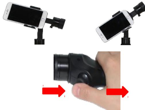
5) Trovare il livello ottimale muovendo il joystick a destra e a sinistra per regolare l'asse orizzontale.
