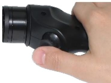
4) Potrete regolare il bilanciamento sull'asse orizzontale muovendo il joystick a destra o a sinistra.
