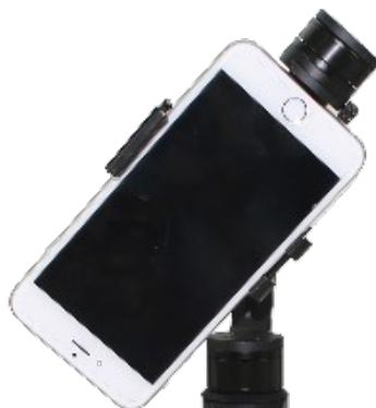
2) Posizionare il contrappeso sul lato del motore dell'asse verticale.
