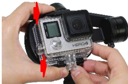
7) Tirare verso il basso la chiusura di fissaggio per serrare il vostro GoPro sul sistema di bloccaggio.
