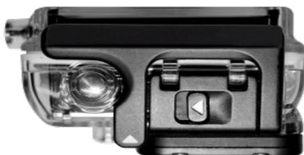
4) Sganciare per aprire la chiusura di fissaggio sul retro del sistema di bloccaggio dell'Husky HY3M.
