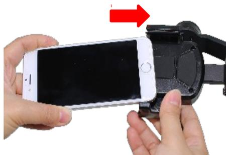
4) Agganciare la chiusura di fissaggio per serrare il vostro dispositivo sul sistema di bloccaggio.
