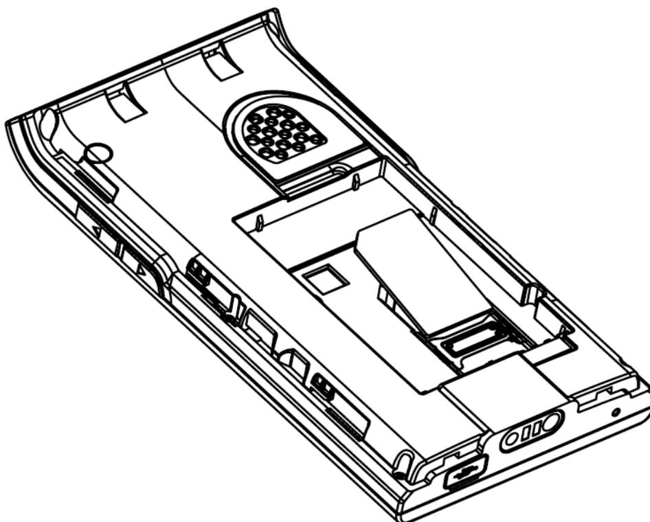
**Suggerimento:** inserire l'estremità con l'angolo tagliato della scheda SIM nell'alloggiamento, mantenendo la superficie in metallo verso il basso.
