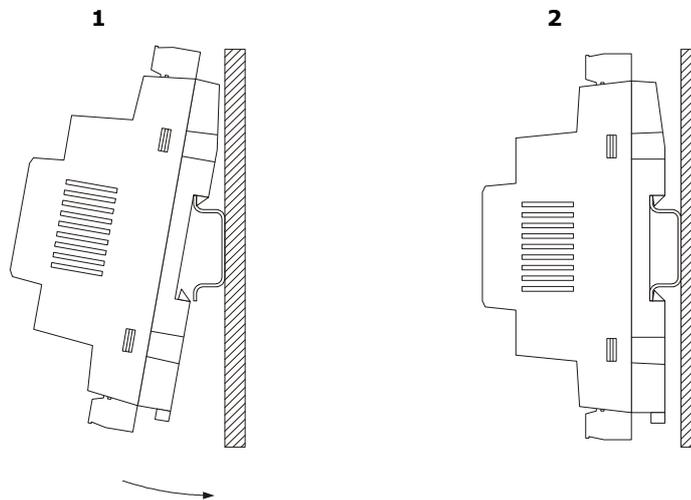
Per rimuovere i dispositivi rimuovere prima eventuali morsettiere a vite estraibili inserite nella parte bassa, quindi operare sulla clip della guida DIN con un cacciavite come indicato nel seguente disegno.
