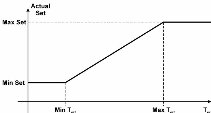
Si differenziano due curve climatiche e set point per il funzionamento Estate o Inverno separando il funzionamento della valvola nelle due stagioni.
