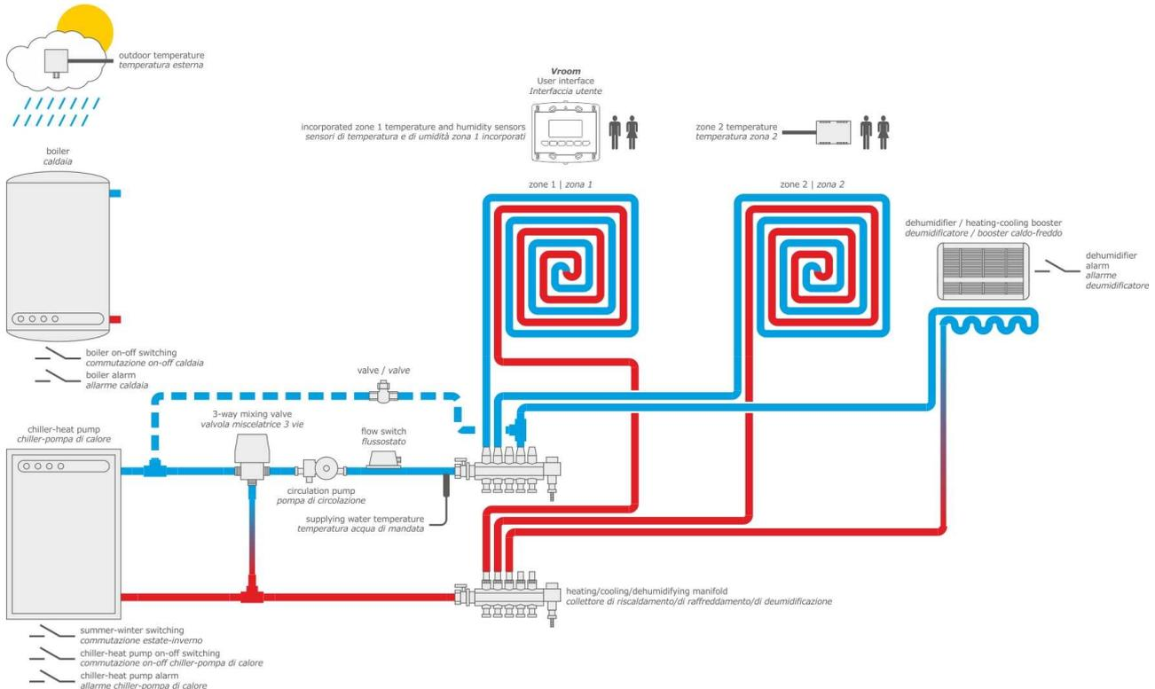
**N.B.** lo schema applicativo sopra riportato è di principio, e ha dunque lo scopo di indicare la presenza dei componenti presenti sull'impianto coinvolti nel controllo e regolazione dei controllori EVCO e non la loro posizione di montaggio o aspetti costruttivi dell'impianto stesso.
