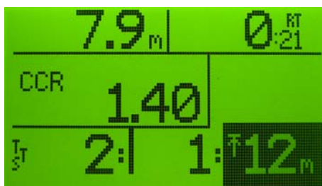
Figura 35: Schermata principale in immersione – Circuito Chiuso (CCR) – Set Point 1,40 – Sosta di Decompressione Omessa: 12 m / 1 minuto tempo necessario all'emersione 2 minuti
