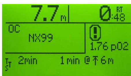
Figura 34: Schermata principale in immersione Circuito Aperto – Gas: Nitrox 99 – Sosta di Decompressione a 6 m per 1 minuto tempo necessario all'emersione 2 minuti Avviso PO2 troppo elevata: 1,76
