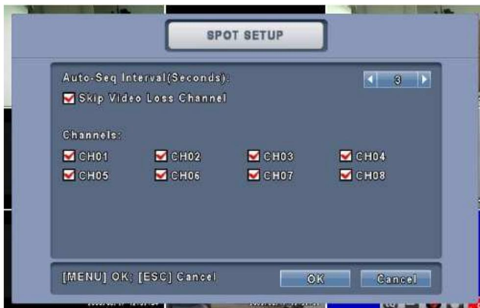
Il DVR ha due modalità di uscita video: l'uscita principale, e quella spot. E' possibile configurare l'uscita SPOT in modo che si abbia la ciclata dei canali desiderati su questa uscita. E' possibile monitorare tutti i canali nella modalità SPOT.
