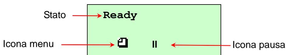
**Nota: Con lo stato Ready, premendo l'icona || si controllerà lo stato del tensiometro della batteria. (Premere di nuovo lo stesso tasto per tornare allo stato Ready)**
