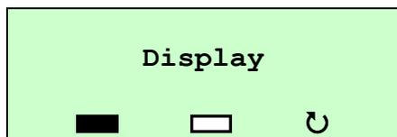
Premere il tasto sotto l'icona per controllare se ci sono punti bianchi sul display. Il display LCD diventerà nero e premere qualsiasi tasto per tornare al menu Display.
