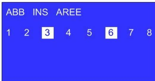
Dopo aver inviato la programmazione premendo il tasto SU i led smettono dell'inseritore di lampeggiare a confermare l'avvenuta programmazione. Rimuovere il jumper e l'inseritore è pronto per funzionare.
