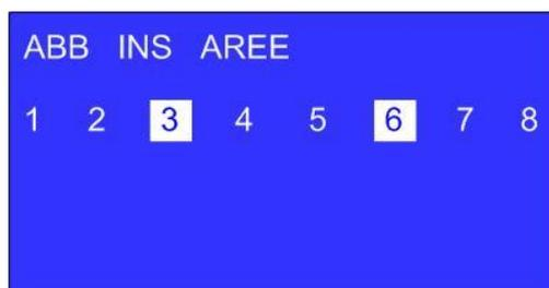
Dopo aver inviato la programmazione premendo il tasto SU i led smettono dell'inseritore di lampeggiare a confermare l'avvenuta programmazione. Rimuovere il jumper e l'inseritore è pronto per funzionare. **N.B. All'inseritore si possono abbinare o un'area o tre aree.**
