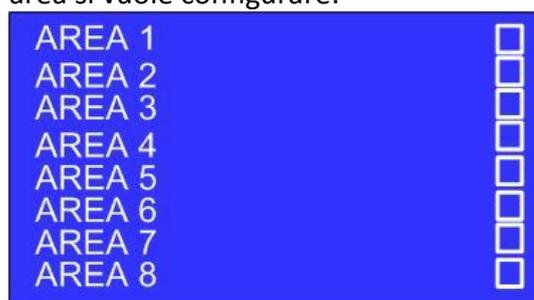
Selezionata un'area si passa al menù di configurazione dell'area dove è possibile configurare le zone associate, le uscite associate, gli 6 numeri da chiamare per effettuare chiamate vocali, gli 6 numeri per l'invio di sms in caso di allarme dell'area e il suo nome. L'ultimo parametro che è possibile configurare per ogni area è il tempo d'uscita dell'area.
