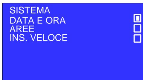
Dove con data e ora si può impostare la data e l'ora del sistema, scegliendo aree è possibile abbinare le zone, le uscite, i numeri da chiamare in caso d'allarme e cambiare il nome di una delle 8 aree. In fine la voce inserimento veloce, abilita la tastiera all'inserimento veloce delle aree.
