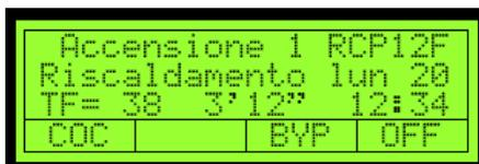
In questa fase la ventola dello scarico fumi è portata alla velocità specificata dal parametro **F\*RI** (o **S\*RI** nel caso di motore senza encoder), il motore della coclea è azionato in base ai tempi specificati dai parametri **C\*NR** e **C\*FR** e la resistenza è mantenuta accesa alla massima tensione, il tutto per il tempo specificato dal parametro **A\*RI**.
