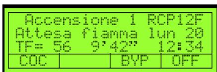
In questa fase la ventola dello scarico fumi è portata alla velocità specificata dal parametro **F\*AF** (o **S\*AF** nel caso di motore senza encoder), il motore della coclea è attivato in base ai tempi specificati dai parametri **C\*NA** e **C\*FA** ed il controller attende che la temperatura rilevata dalla termocoppia dello scarico fumi superi il valore specificato dal parametro **A\*TF**, garantendo così il fatto che la fiamma sia effettivamente accesa.
