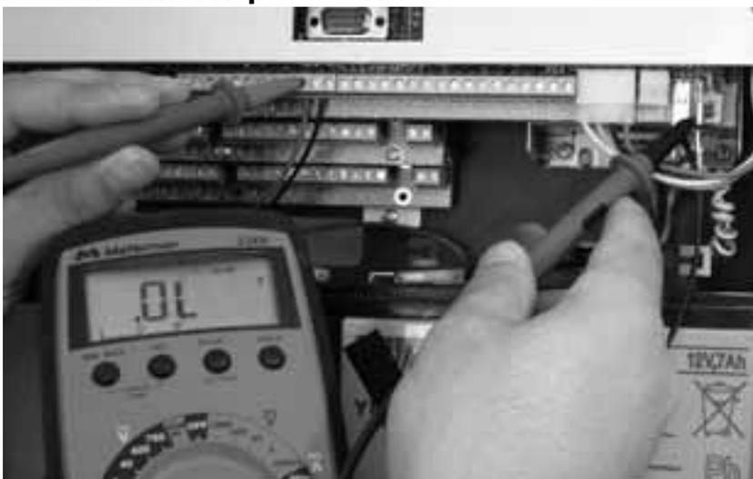
**Figura 35 - Isolamento tra cavi e terra**
