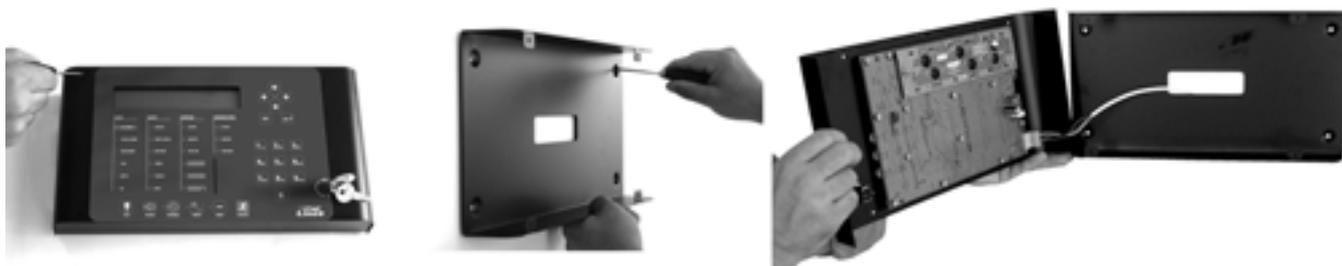
**Figura 11 - Fissaggio repeater**
