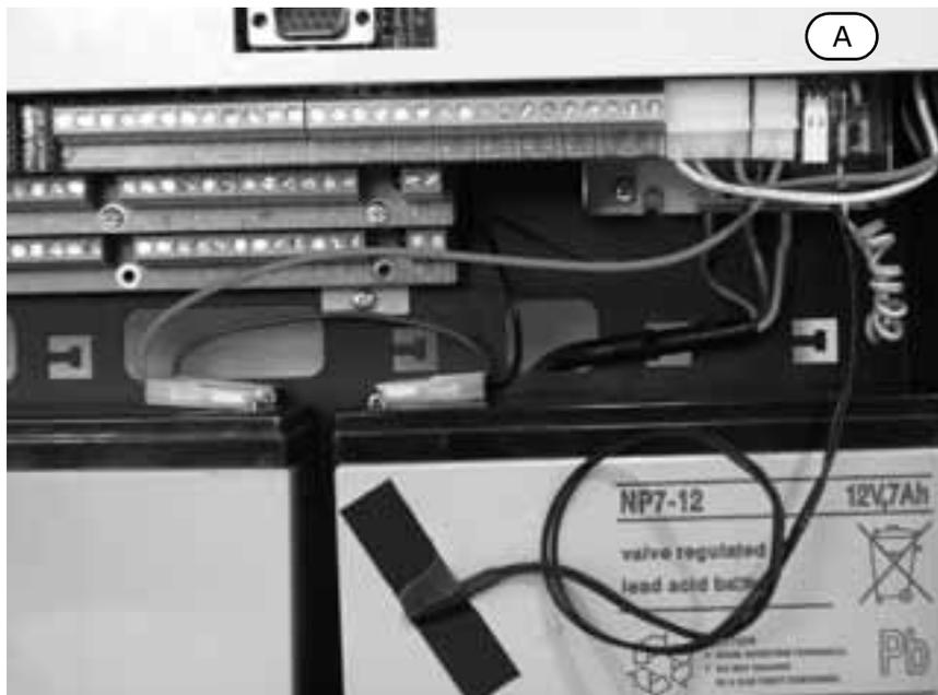
**Figura 32 - Connessione della sonda termica**
