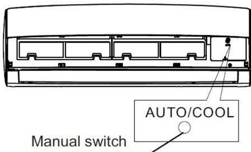
**NOTA:** L'unità deve essere spenta prima di azionare il pulsante del controllo manuale. Se l'unità è in funzione, continuare a premere il pulsante del controllo manuale fino a quando l'unità è spenta.
