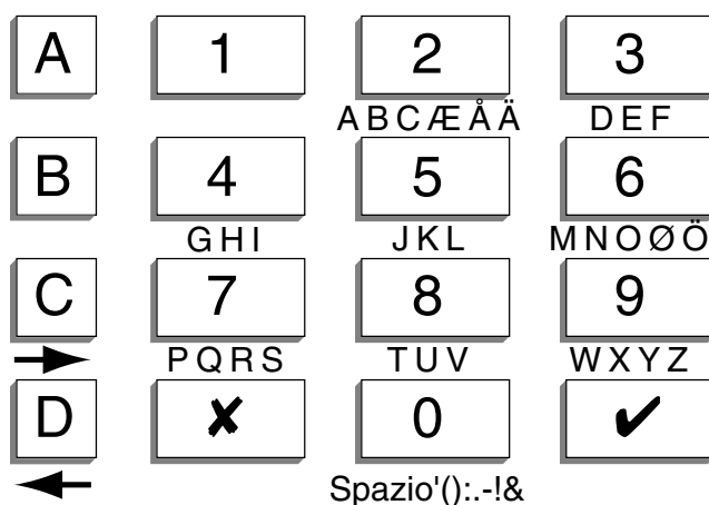
Figura 4. Lettere generate da ogni tasto numerico
