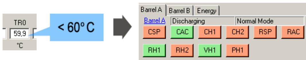
Quando **CAC** è aperto, il controllo parte guardando il livello per indicare il cambio. Quando il livello è inferiore a 40% inizia a guardare a **TC0**. Se **TC0** è maggiore di 15°C (MaxTC0Temp) e **TC0** diviso per **TR1** è maggiore di 0,67 (MaxTC0DivTR1), il serbatoio viene considerato vuoto. Se il livello è inferiore a 3% (LevelEmpty) per 15 minuti (LevelEmptyRunTime) è anche considerato vuoto.
