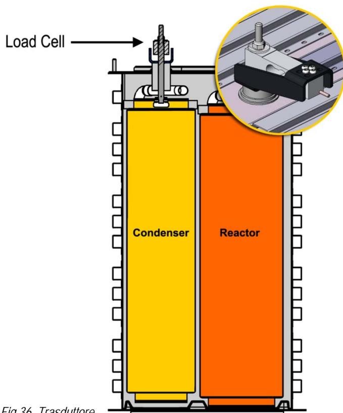
Fig 36. Trasduttore
