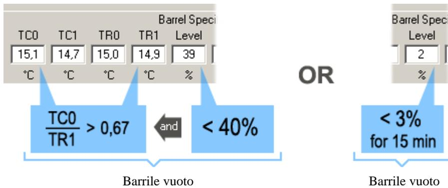
Quando vuoto, RH1 (o RH2 se usato) si chiude tenendo CAC aperto fin quando il barile raggiunge il livello  $\geq 80\%$  (LevelLoaded) e viene eseguito un cambio.
