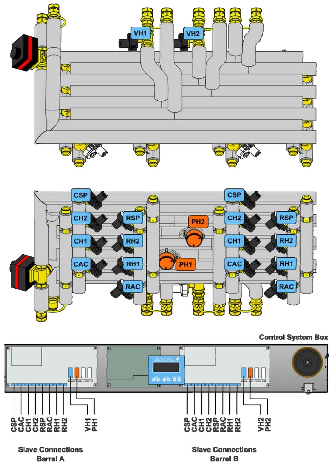
Fig 35. Collegamenti autocomandati, serbatoio A e B.
