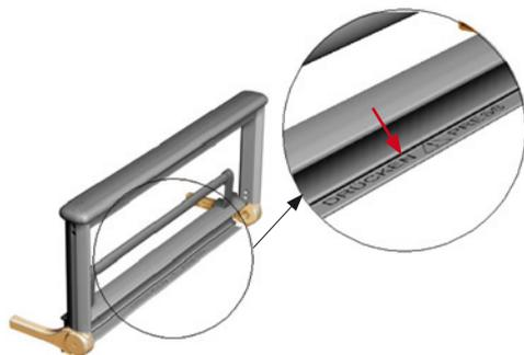
3. Spingere completamente l'elemento della sponda sotto il piano rete.
