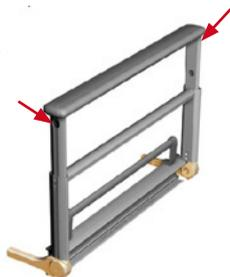
2. Azionare il dispositivo di scatto contrassegnato con "Drücken / Press" all'estremità inferiore della sponda laterale ed inclinare quest'ultima di lato in orizzontale, in modo che risulti parallela al pavimento.
