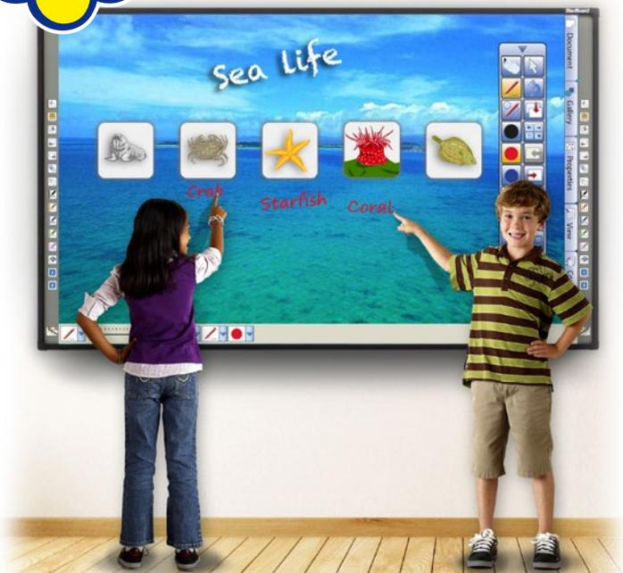
Lavagna interattiva Hitachi serie Duo che permette input simultanei utilizzabile con una o due dita/oggetti o con penna elettronica, anche da due persone contemporaneamente, superficie bianca rigida, antiriflesso e robusta.
