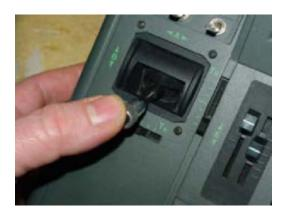
Spostare ora il trim (oppure l'interruttore engine cut in caso di trim digitali) alla posizione di minimo e lo stick motore alla minima potenza e prevere nuovamente il pulsante "+" del data terminal
