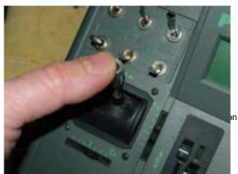
Portare sul vostro trasmettitore sia lo stick del motore che il trim alla posizione massima.
