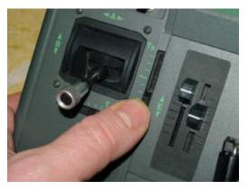
A questo punto lasciare lo stick del motore al minimo e portare anche il trim nella posizione di minimo ovvero di motore spento (nel caso adottiate un interruttore al posto del trim metterlo in posizione off); a questo punto premere ancora il pulsante "+" del pannello.
