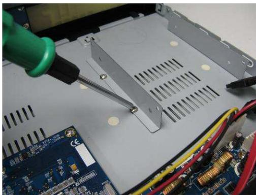
b) Prendere un HDD SATA compatibile e collegarlo al connettore di alimentazione e al collegamento bus dati.
