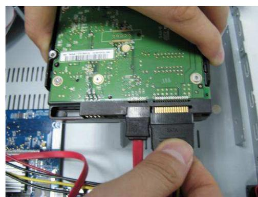
c) Inserire l'HDD nel DVR, e fissare l'HDD SATA nel DVR.
