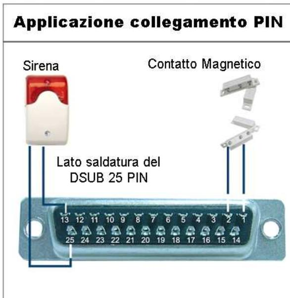
**Sirena:** quando il DVR si avvia per un allarme o movimento, la COM si collega con NO e la sirena con luce rotante inizia a suonare e a lampeggiare.
