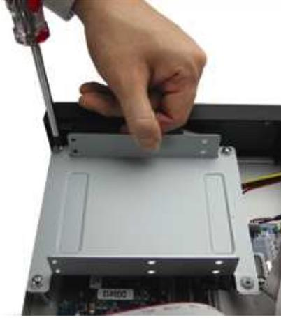
b) Procurarsi un HDD SATA compatibile. Inserire l'HDD sul supporto e fissarlo con due viti per ciascun lato. Vi sono tre fori per le viti su ciascun lato del supporto ed è possibile sceglierne due per fissare l'HDD.
