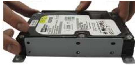
b) Collegare l'HDD al connettore di alimentazione e al collegamento bus dati.
