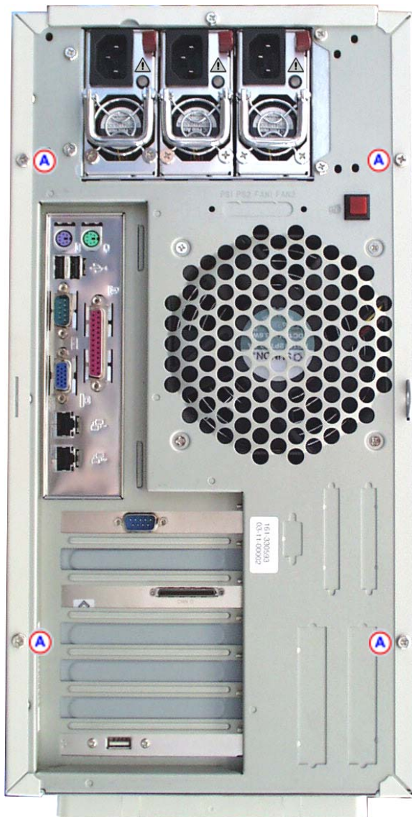
Figura 4. Rimozione della copertura
