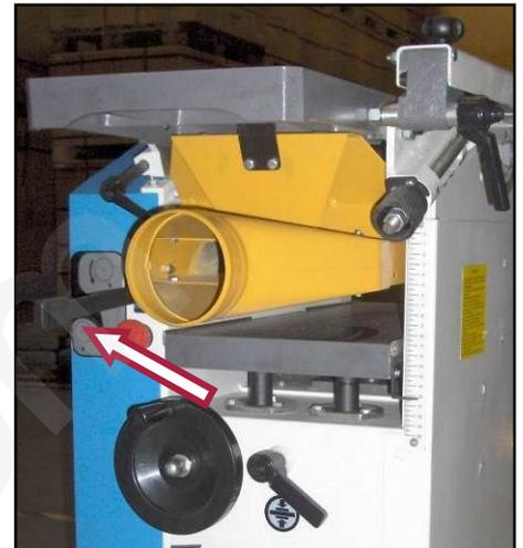
Figura 11 – Leva rullo di avanzamento.
