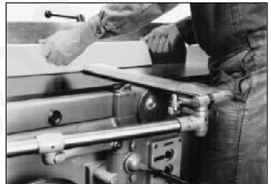
Figura 33 – Piallatura con guida inclinata a 45°.
