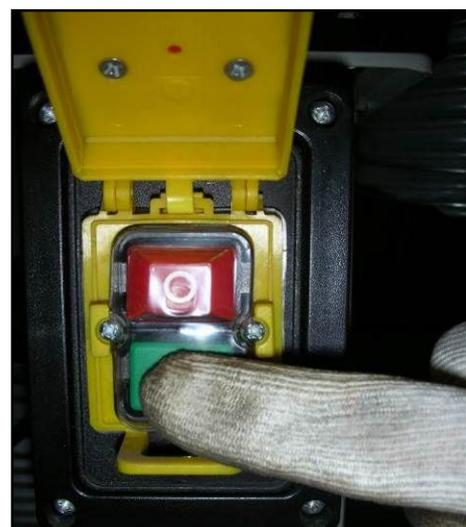
Figura 8 – Avviamento della macchina.
