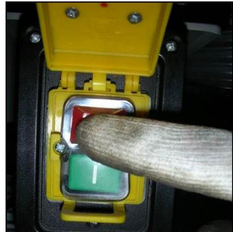
Figura 9 – Arresto della macchina.
