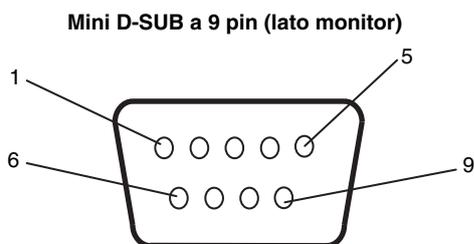
Questo monitor LCD utilizza linee RXD, TXD e GND per il controllo tramite RS-232C.
