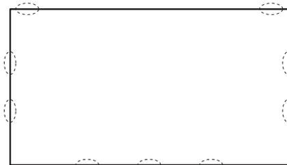
Fissaggio mediante nastro biadesivo: l'unità sensore può essere collocata su qualunque lato del monitor.
