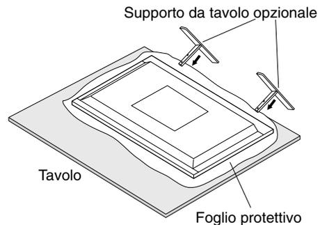
**NOTA:** Installare il supporto in modo che l'estremità lunga dei piedini sia rivolta in avanti. Utilizzare l'ST-5220 per X555UNS/X555UNV.
