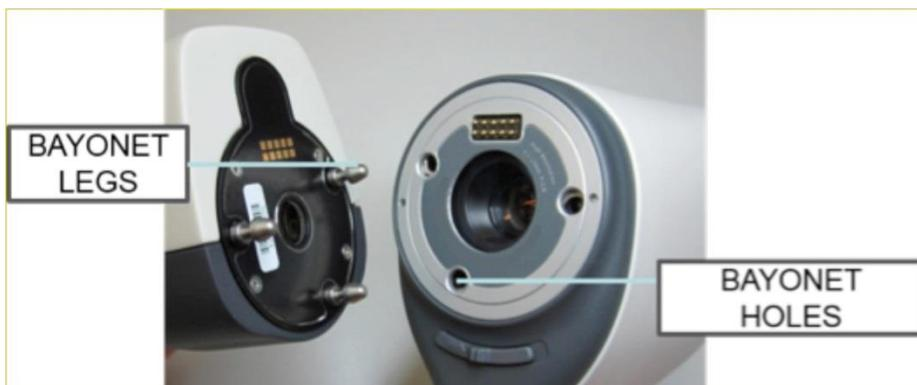
Il modulo ottico è montato ponendolo avanti all'area a baionetta del dispositivo. I tre attacchi a baionetta sono messi nei fori e il modulo ottico è premuto in modo fermo nel dispositivo
