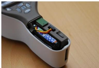
4. Mettere la nuova batteria nella stessa posizione e collegare il connettore alla presa apposita.
