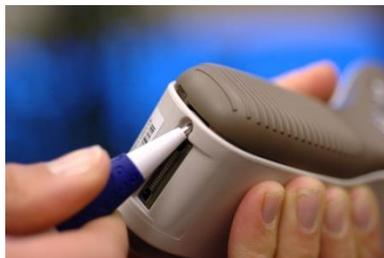
1. Aprire la copertura del comparto batteria spingendo e inclinando la chiusura a scatto attraverso il foro vicino al connettore sul fondo del dispositivo. È possibile usare una penna, un cacciavite o un piccolo dispositivo appuntito simile per aprire la copertura.
