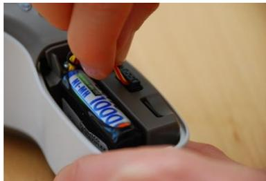
3. Rimuovere la vecchia batteria. Stringere i cavi della batteria con le dita e tirare il connettore dalla presa.
