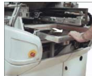
5. Sollevare con cautela la cassetta di pulizia dai due perni e sfilare da sotto la barra del solvente.
