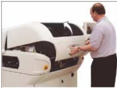
7. Accedere al supporto della cassetta e inserire la cassetta di pasta nel supporto. Staccare il sigillo. Riassemblare il supporto nella testina di trasferimento.
