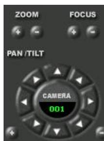
○ **PULSANTI PTZ** – Se avete collegato alla porta RE-485 del videoregistratore delle telecamere speed dome potete controllarle con i pulsanti PTZ che sono posti in basso a destra. Scegliete la telecamera con i pulsanti +/- in basso nello schermo in modo che il suo numero compaia nella finestrella sotto la voce CAMERA. Poi agite sui pulsanti direzionali di spostamento e sui pulsanti per il controllo dello ZOOM +/- e del FUOCO (FOCUS) +/-.
