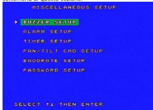
◦ **BUZZER SETUP (CICALINO INTERNO)** – Il videoregistratore è munito di un buzzer interno per segnalare diverse situazioni funzionali. E' possibile attivarlo o escluderlo selezionando le voci del sottomenu con i tasti SU/GIÙ e poi scegliendo ON/OFF (attivo/spento) con i tasti DESTRA/SINISTRA. Sono disponibili le seguenti voci.
