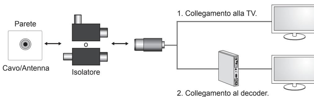
Collegare un'estremità dell'isolatore al jack del cavo/antenna e l'altra al decoder o al set della TV,
