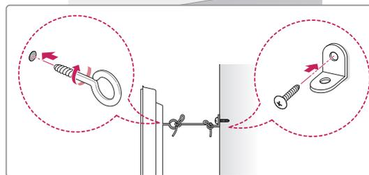
1. Inserire e fissare i bulloni a occhiello o le staffe del televisore e i bulloni sul retro del televisore.
