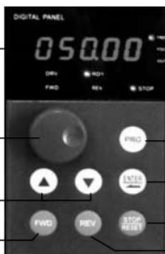
Area del display principale: può mostrare valori come modi di settaggio, frequenza in atto, tensione di uscita corrente, anomalie
