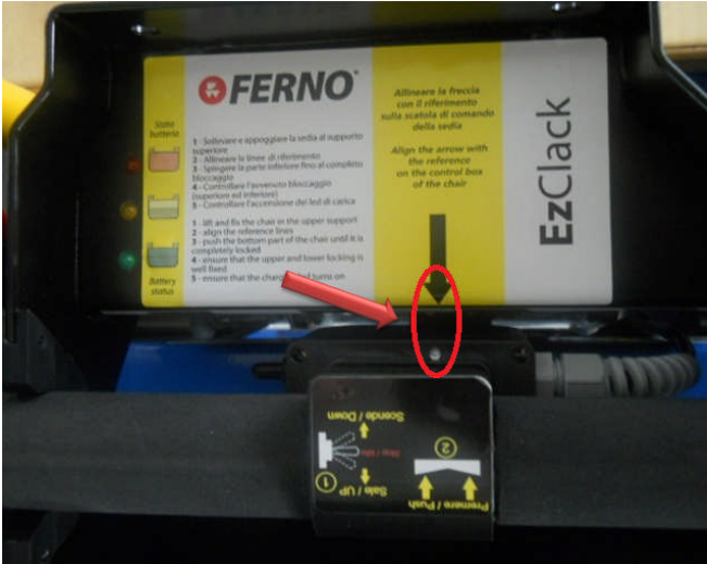
Figura 4: Allineamento dei riferimenti sulla scatola di comando della sedia EZ-Glide Power e sull'etichetta apposta su EzClack Power.
