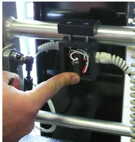
Figura 14a: Allineamento spina di carica e presa di carica.
