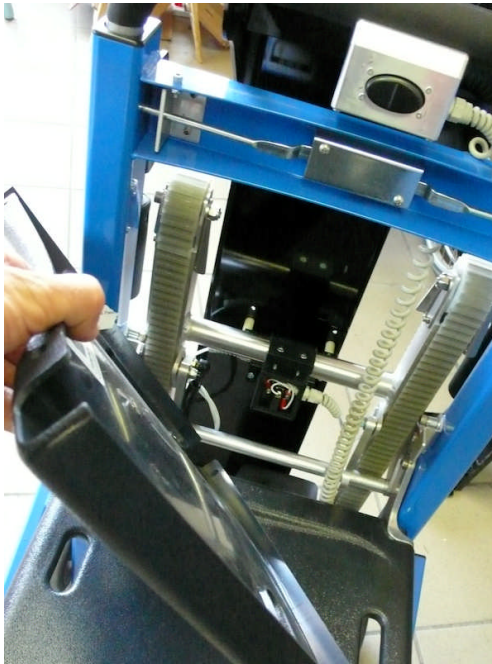
Figura 12: Rimozione della copertura dello schienale e del coperchio della spina di carica.
