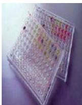
E' un sistema multifunzionale per l'esecuzione semiautomatica di antibiogrammi e identificazioni batteriche in micro diluizione.
