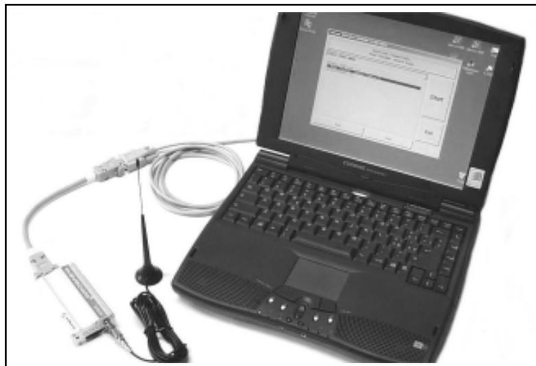
Il software "TELECON" provvede alla connessione con la stazione attraverso la linea telefonica o modem GSM fornendo il collegamento con la stazione, e realizzando a distanza le tipiche operazioni come: il reset di tutti gli allarmi, accensione e spegnimento del trasmettitore, abbassamento della potenza erogata, provvede ai test sui carichi fittizi, ecc., quindi attraverso l'analisi, per rilevare gli eventuali guasti e per indicare i pezzi di ricambio necessari per ripararla.
