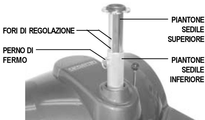
FIGURA 17. REGOLAZIONE ALTEZZA DEL SEDILE
