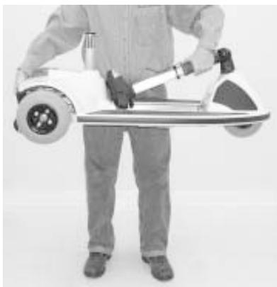
FIGURA 23. SOLLEVAMENTO AD OPERA DI UNA SOLA PERSONA (GRUPPO BATTERIE/CARICABATTERIE ASPORTATO)
