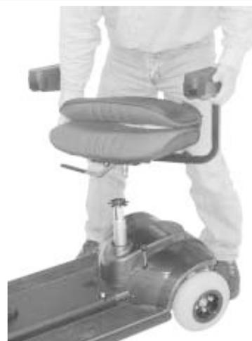
FIGURA 18. RIMOZIONE DEL SEDILE
